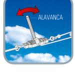
Proceda o esticamento da tela utilizando-se de um esticador de catraca posicionado na extremidade oposta da amarração inicial da tela. Cuidado ao tracionar a tela.
