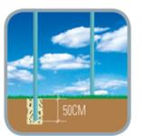
Cavar buracos com profundidade de 50cm para colocação dos mourões de concreto ou madeira. Deve-se prestar atenção ao alinhamento e a altura dos mourões.
