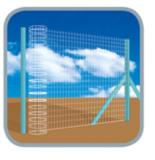
Proceda a fixação da tela ao primeiro mourão (esticador) utilizando-se de arame Tellacor.
