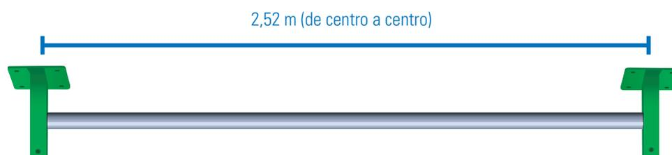
Quando for fazer instalação do gradil parafusado, posicione o gabarito com a base para baixo:
