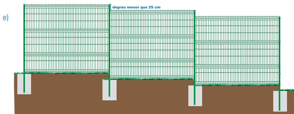
Em terrenos com desnível, antes de iniciar a instalação, é preciso analisar os níveis de inclinação da área. Recomendamos a instalação do **Gradil Morlan®** de forma escalonada (figuras E e F). Neste tipo de instalação, deve-se usar um poste com medida imediatamente superior para evitar que a ponta superior do gradil fique solta. Os degraus devem ter no máximo 25 cm de altura.
