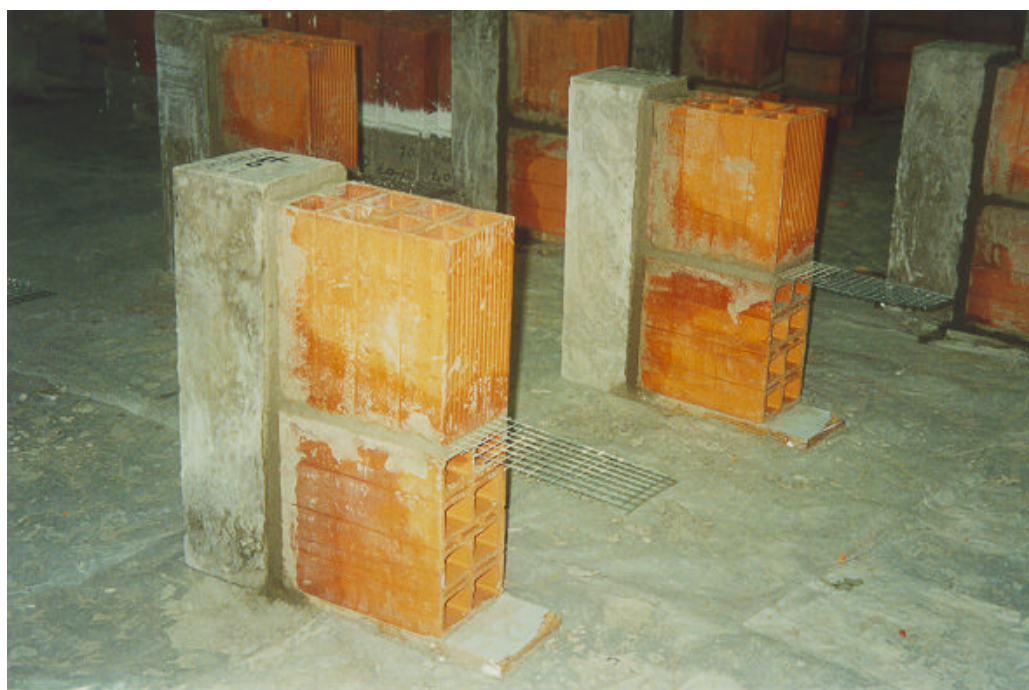
Figura 7 – Corpos-de-prova confeccionados para ensaios de arrancamento do dispositivo fixado ao elemento de concreto armado e ancorado na junta de argamassa de prismas de alvenaria
