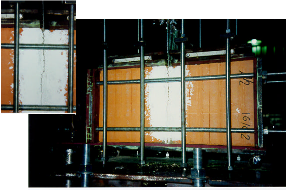
Figura 12 – Ensaio de arrancamento por tração direta do dispositivo ancorado na junta de argamassa de prisma de alvenaria. Observar o detalhe da fissura.
