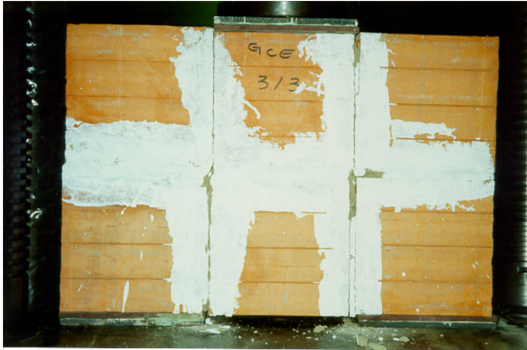
Figura 11 – Ensaio de resistência ao cisalhamento da junta horizontal de pedrinhas de alvenaria reforçadas ou não com dispositivos metálicos.
