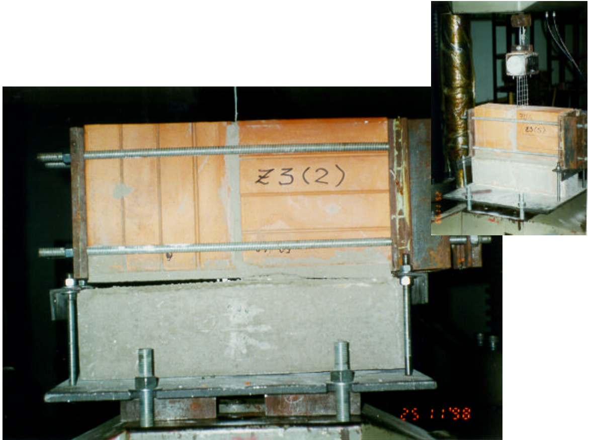
Figura 13 – Aspectos do ensaio de arrancamento por tração direta do dispositivo ancorado na junta de argamassa do prisma de alvenaria e do pilarete de concreto armado.
