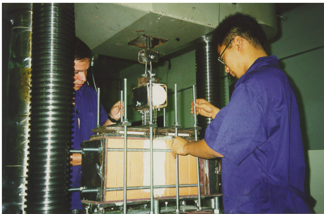
Figura 6 – Aspecto do ensaio de arrancamento à tração onde pode-se notar as barras horizontais destinadas à aplicação de tensões de pré-compressão. Na foto, procede-se à avaliação de uma tela metálica ancorada à junta de argamassa de um prisma de alvenaria.
