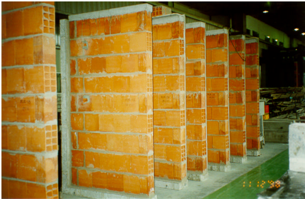
Figura 14 – Aspectos dos corpos-de-prova utilizados nos ensaios de ligação parede-pilar em escala natural. Trata-se de um elemento pré-fabricado em concreto amado sobre o qual era construída a parede em diversas configurações de ancoragem.
