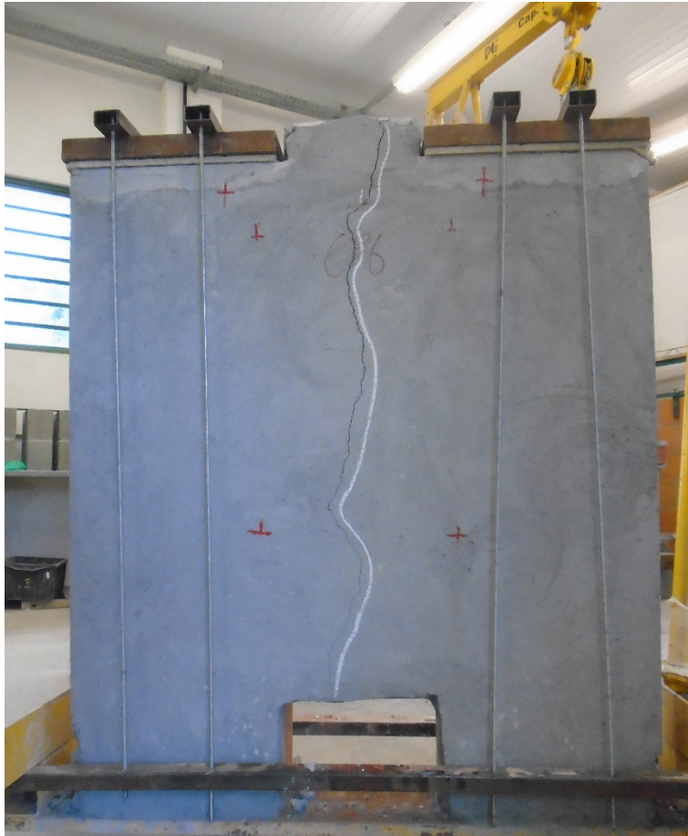
Figura 34 - CP após ruptura - Parede 6
