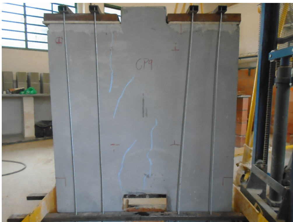
Figura 37 - CP após ruptura - Parede 9
