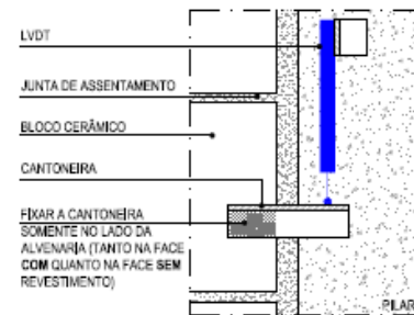
AMPLIAÇÃO - FIXAÇÃO DO LVDT ESC. 1:5
