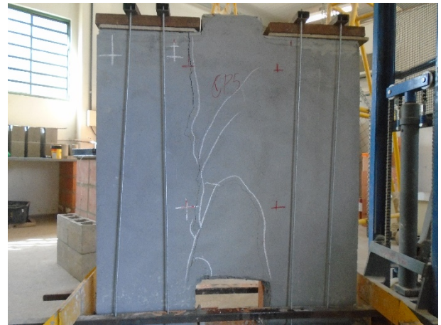
Figura 55 - CP 5 após a ruptura
