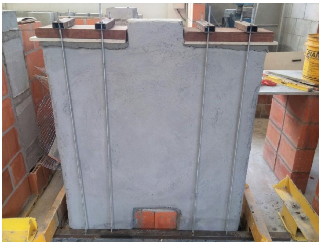
Figura 15 - Esquema de pré-compressão da alvenaria
