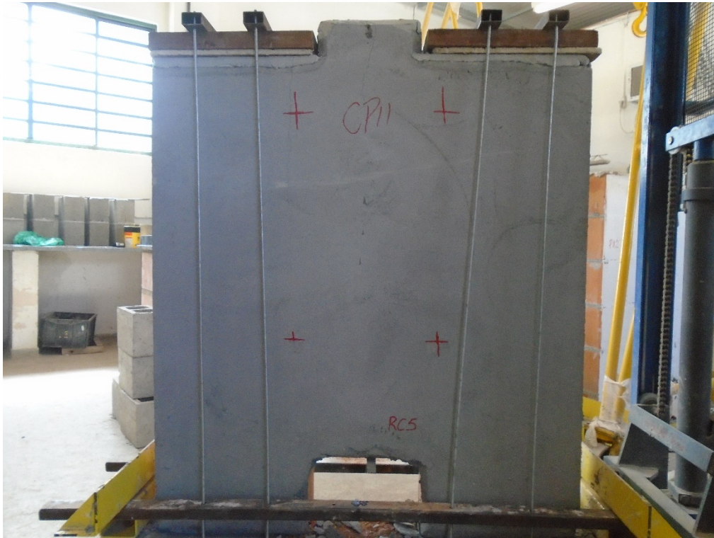
Figura 39 - CP após ruptura - Parede 11
