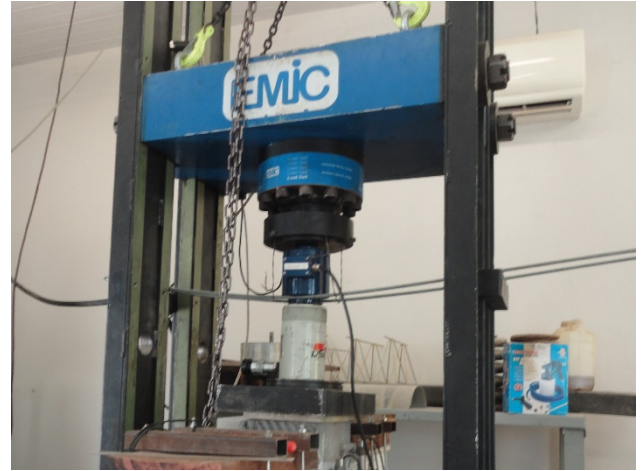
Figura 18 - Pórtico e célula de carga
