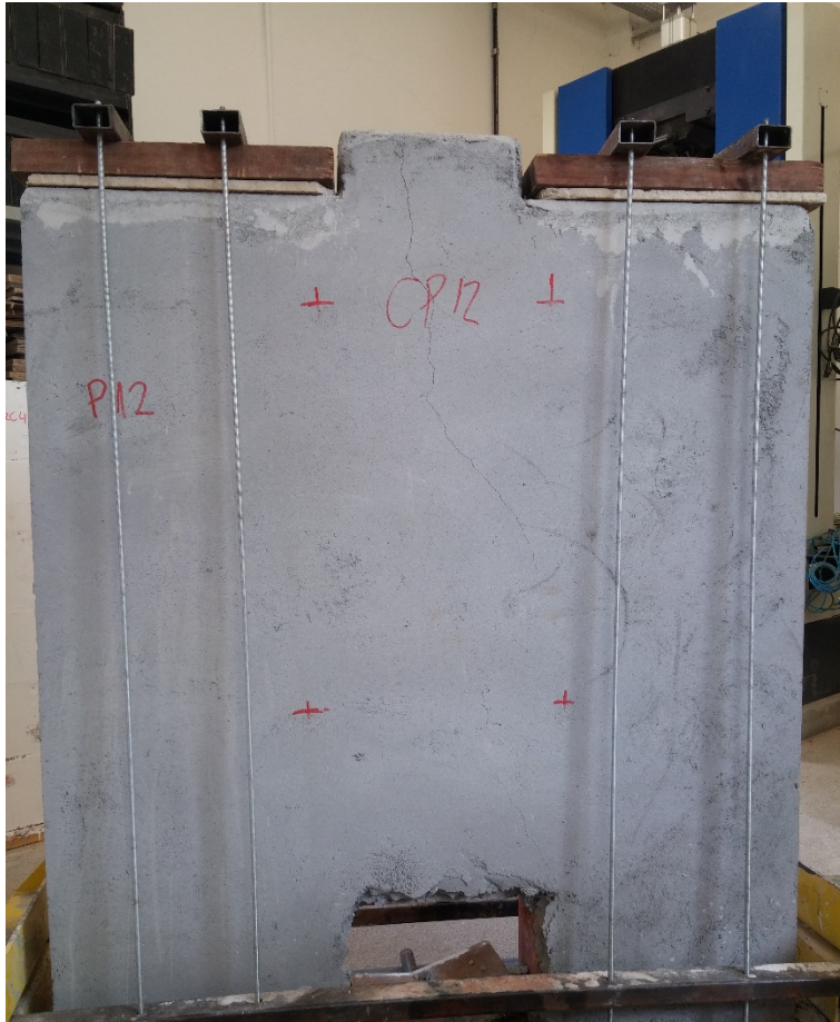
Figura 40 - CP após ruptura - Parede 12
