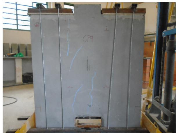
Figura 57 - CP 9 após a ruptura
