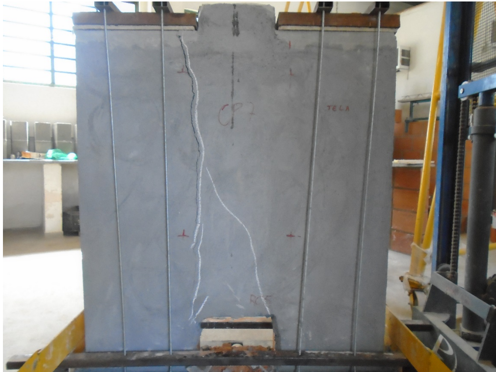
Figura 35 - CP após ruptura - Parede 7
