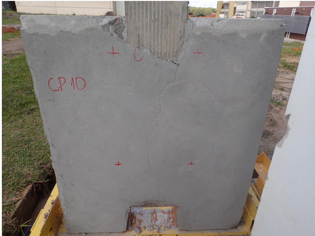
Figura 38 - CP após ruptura - Parede 10
